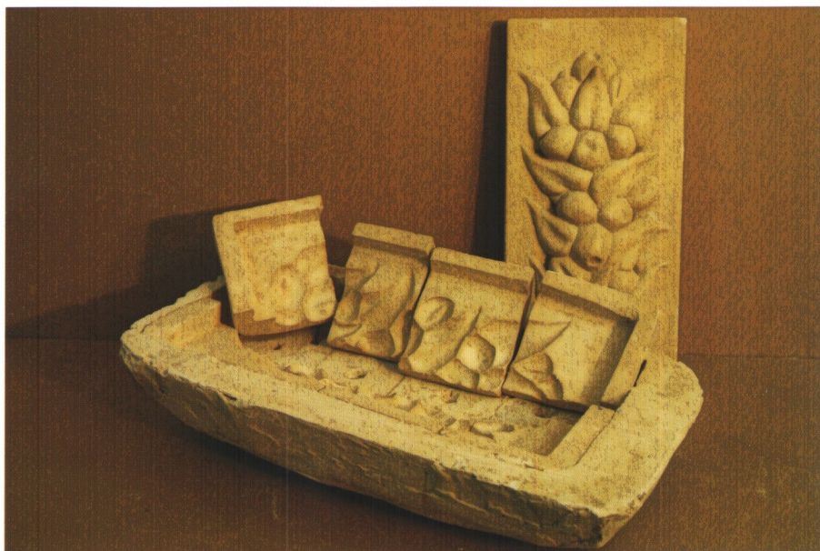
Fot. 4.2.5. Forma klinowa otwarta z płaszczem i model
