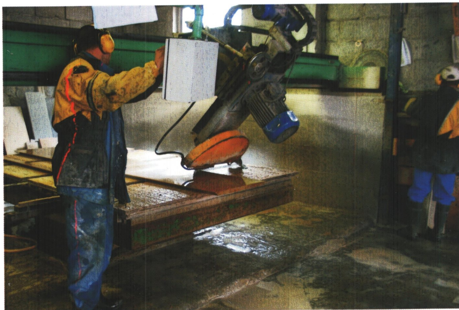
Fot. 4.3.8. Cięcie kamienia piłą formatową
